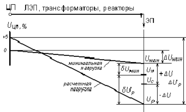
Рис. 4.7. Уровни и графики изменения напряжения вдоль линии при наибольших (расчетных) и минимальных нагрузках
