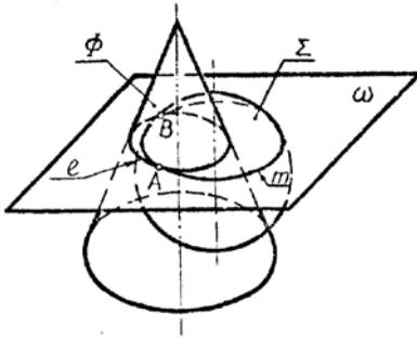
в) отмечают точки  $A$  и  $B$  пересечения линии  $l$  и  $m$  - общие точки двух поверхностей, принадлежащие искомой линии пересечения;
