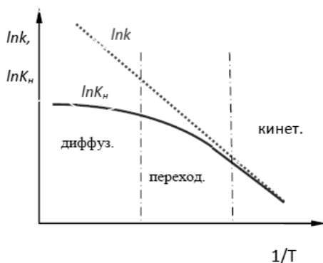
Рис. 30. Зависимость константы скорости реакции k и наблюдаемой константы K_n скорости превращения (сплошная линия) от температуры T в гетерогенном процессе «сжимающаяся сфера» в различных режимах
