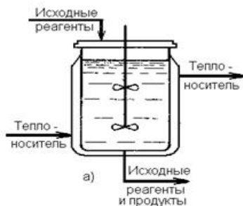
Рис. 1. Схема проточного реактора с мешалкой
