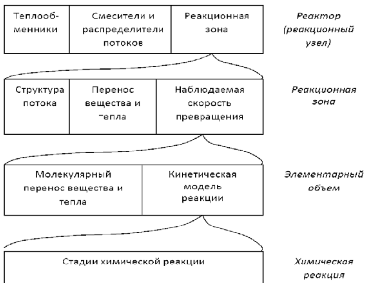
Рис. 3. Иерархическая структура математической модели процесса в химическом реакторе
