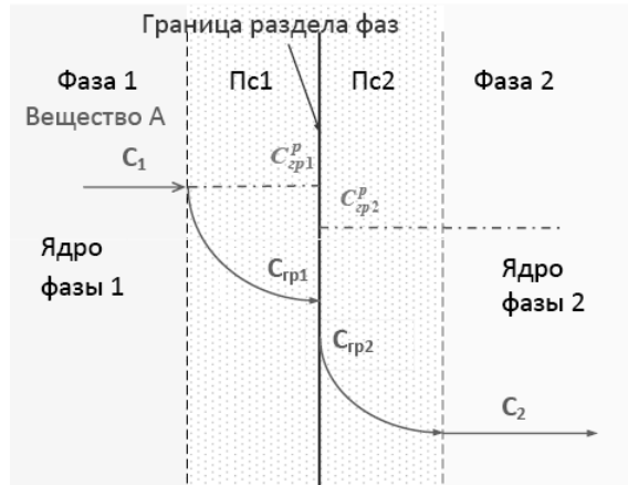
Рис. 25. Профили концентраций у поверхности контакта фаз: в процессе переноса вещества A из фазы 1 в фазу 2 ( \longrightarrow ); в состоянии равновесия ( - \cdot - \cdot - )
