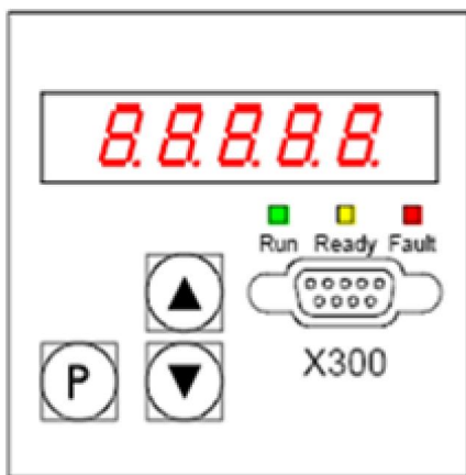
Рис.11. Внешний вид панели PMU « Simoreg »
