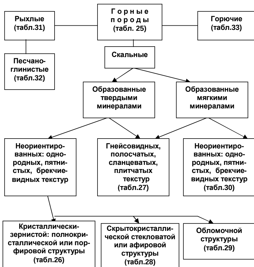
Рис. 34. Определение горных пород. Последовательность операций и логическая схема таблиц
