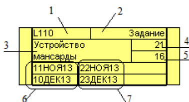
Рис. 33 Прямоугольник работ: 1 – ID код работы; 2 – тип работы; 3 – описание работы; 4 – полный резерв; 5 – частный резерв; 6 – даты раннего начала и окончания работы; 7 – даты позднего начала и окончания работы
