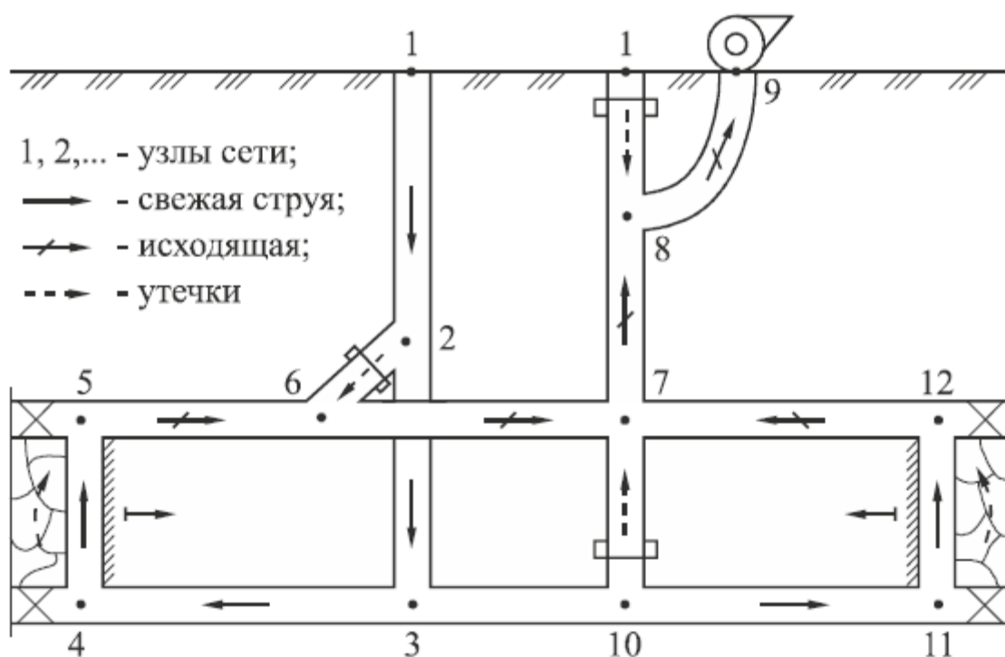
Рис. 2. Схема вентиляции шахты
