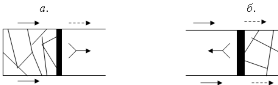
Рис.18. H- образная схема проветривания: а – прямой порядок отработки; б – обратный порядок отработки
