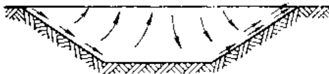
Рис.36. Комбинированная (конвективно-инверсионная) схема проветривания карьера энергией термических сил
