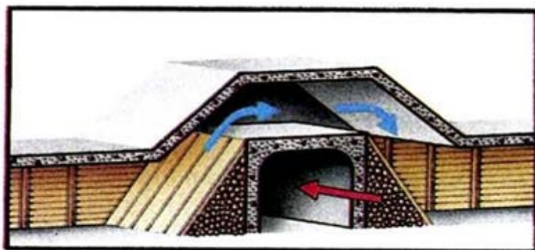
Рис.12.Кроссинг типа перекидного моста
