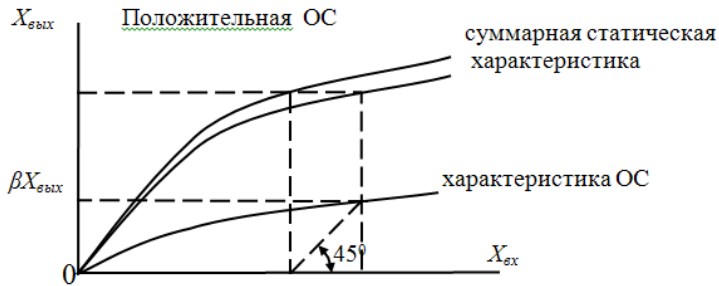
Рис.2.2. Графический метод построения суммарной статической характеристики при положительной обратной связи:
