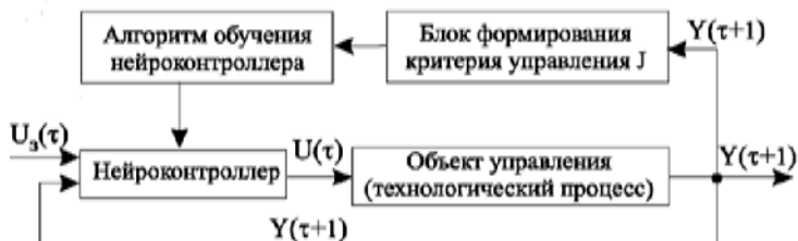
Рис. 8.9. Структурная схема нейросетевой системы управления, оптимизированной путем использования эталонной модели оптимального управления технологическим процессом
