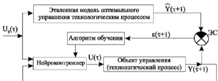
Рис. 8.10. Структурная схема нейросетевой системы управления с экстремальным законом управления
