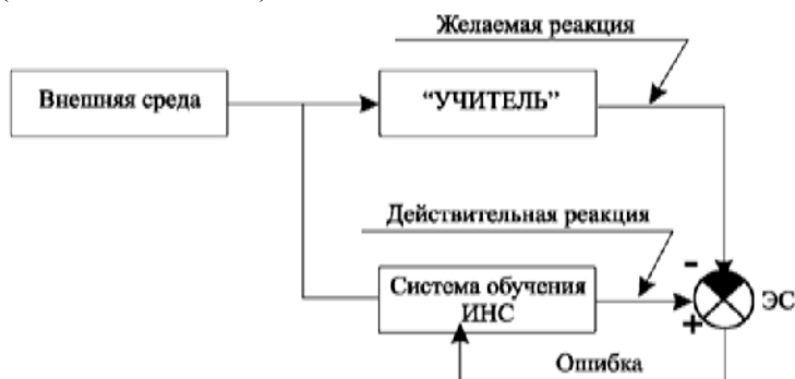
Рис. 8.5. Схема прямого контролируемого обучения
