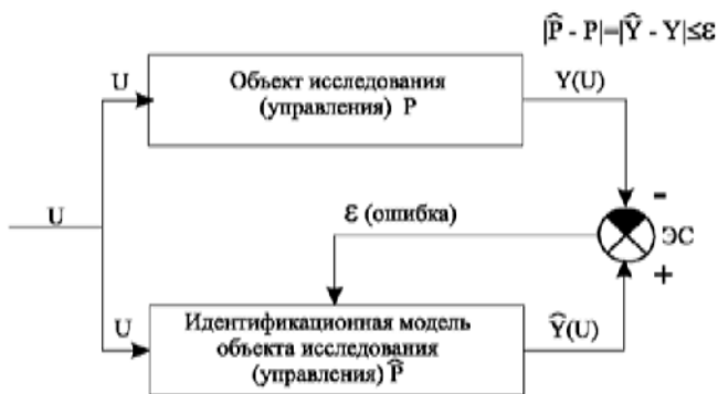
Рис. 8.7. Схема идентификации объекта исследования (управления)
