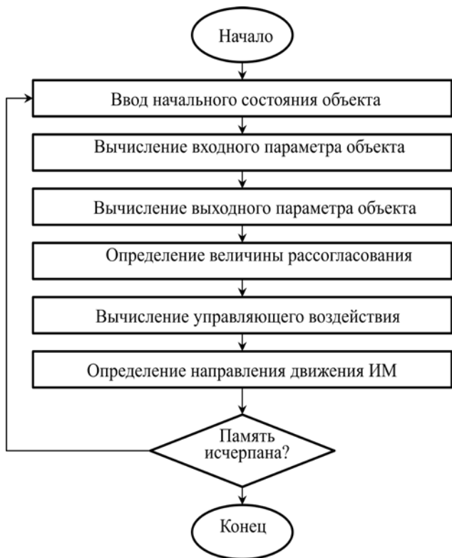
Рис. 10.6. Алгоритм расчета переходного процесса в контуре цифрового регулирования
