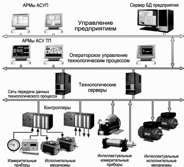
Рис. 2.7. Структура современной промышленной системы АСУП
