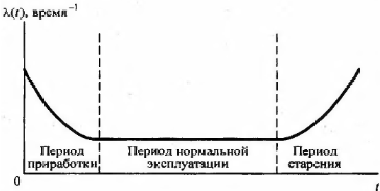
Рис. 2.1. Зависимость интенсивности отказов от наработки
