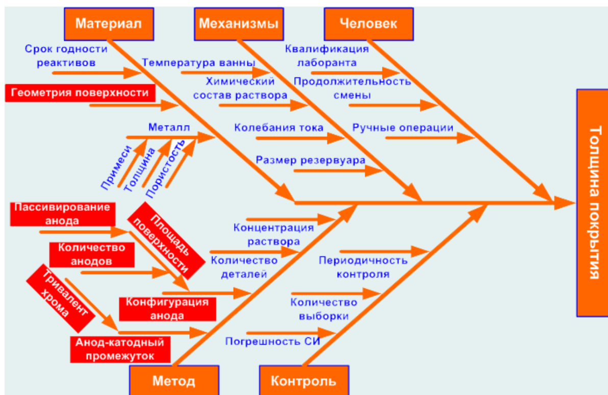
Рис.4. Диаграмма Исикавы определения причин неравномерной толщины покрытия, наносимого гальваническим способом на металлические детали
