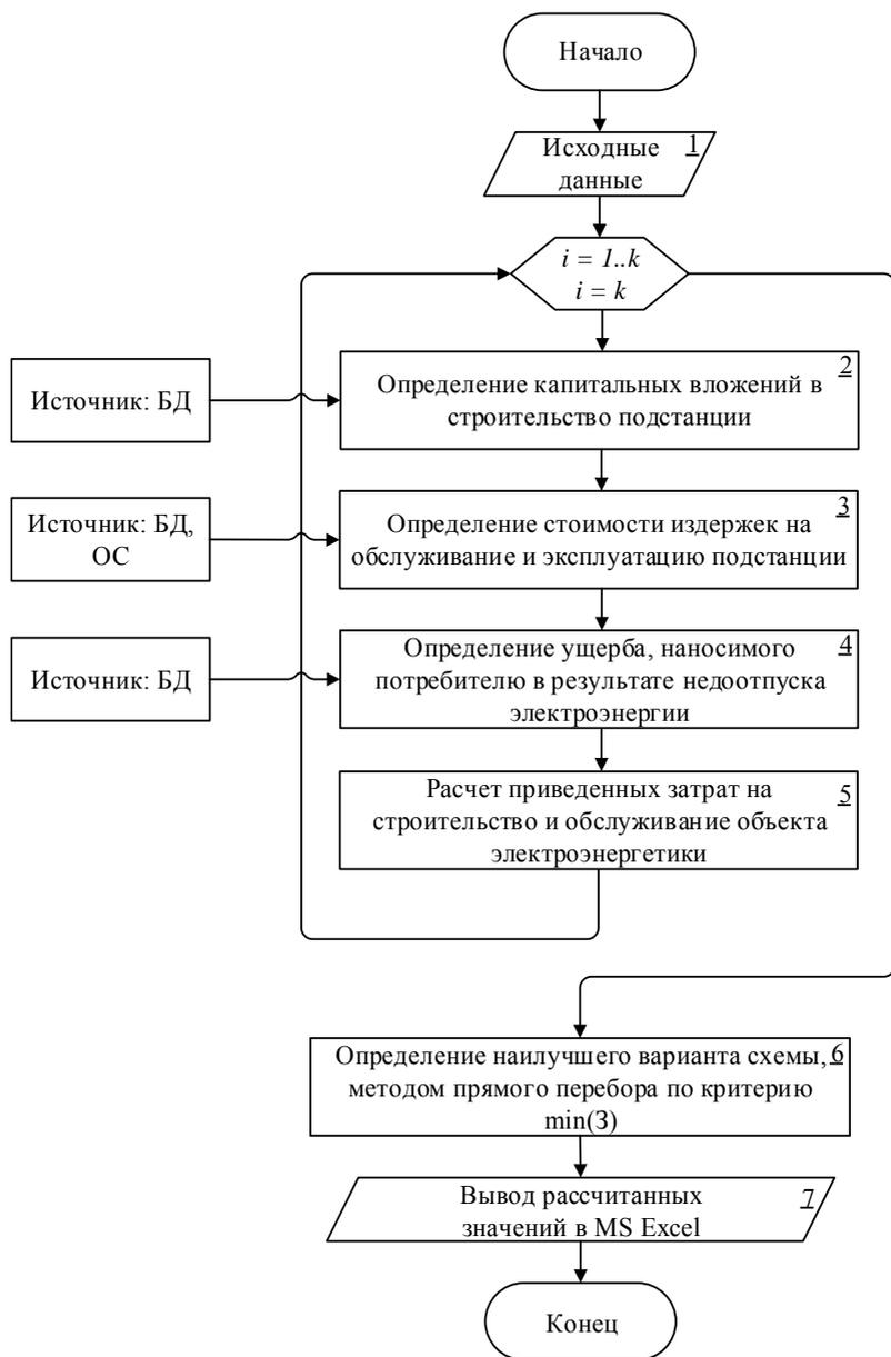
Рис. 4.5. Блок-схема методики технико-экономического сравнения вариантов схем открытых распределительных устройств 35 кВ и выше
