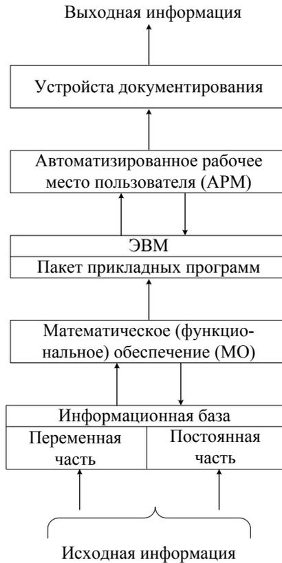
Рис. 1. Структурная схема САПР
