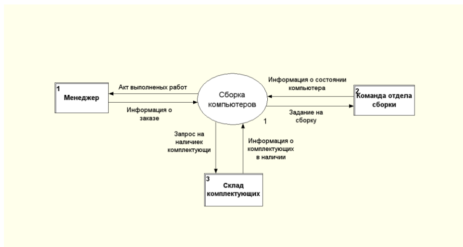
Рис. 2.4. Функциональная модель процесса обработки информации в нотации DFD. Контекстная диаграмма
