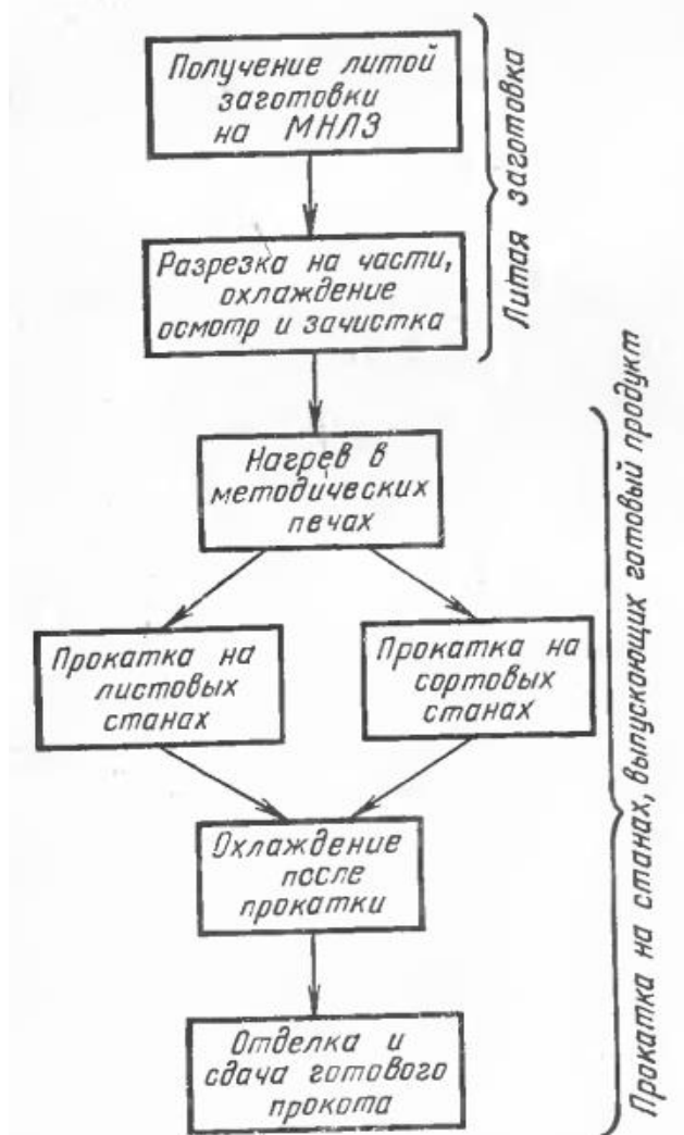
Рис. 4.3. Технологическая схема производства проката из заготовок, полученных на МНЛЗ
