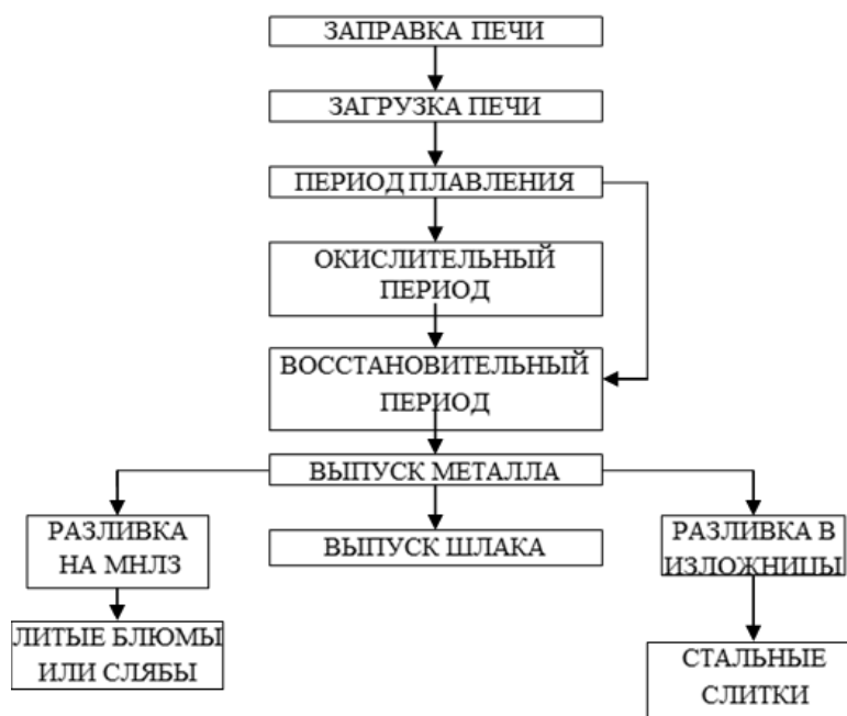
Рис. 3.9. Схема технологического процесса производства стали в дуговых электропечах
