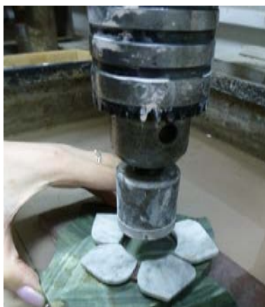
Рис. 82. Сверление отверстия под часы
