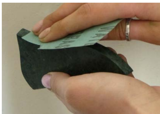
Рис. 80. Ручная доводка деталей настольного прибора
