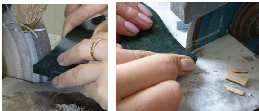
Рис. 79. Предание элементам изделия плавных линий
