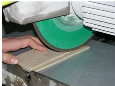
Рис. 100. Разметка заготовок. Рис. 101. Резка пластин на заготовки
