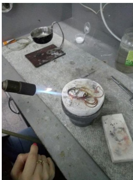
Рис. 70. Пайка детали «Хвост» а) Вторая деталь хвоста; б) Пайка детали
