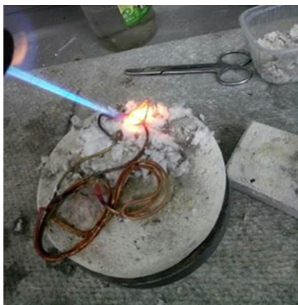
Рис. 71. Пайка детали а) Изготовление детали; б) Пайка детали
