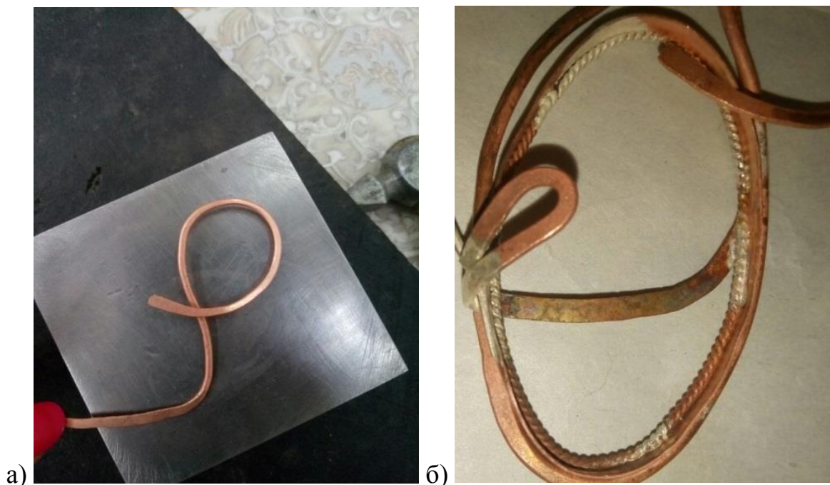
Рис. 69. Пайка детали а) Первая деталь хвоста; б) Пайка детали
