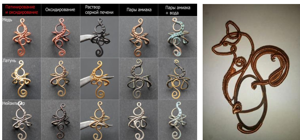
Рис.81. Процесс патинирования а) Таблица с патинированием; б) Патинирование и оксидирование
