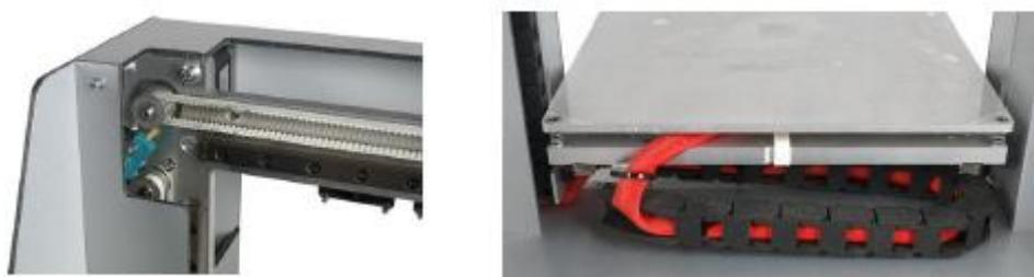
Рис. 2.1.21. Зубчатые ремни и движущая основа
