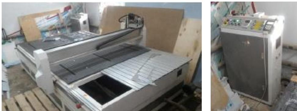
Рис. 2.2.2. Фрезерно-гравировальный станок с ЧПУ и пульт управления ЧПУ
