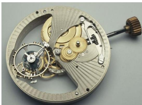
Рис. 1.4.3. Механизм прибора из нейзильбера
