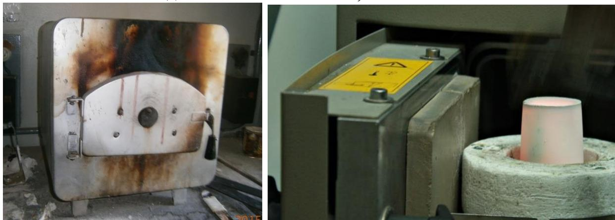
Рис. 1.3.11.-1.3.12. Прокаливание опок
