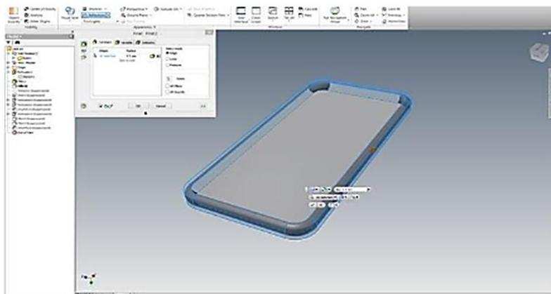
Рис. 1.1.20. Создание углового профиля
