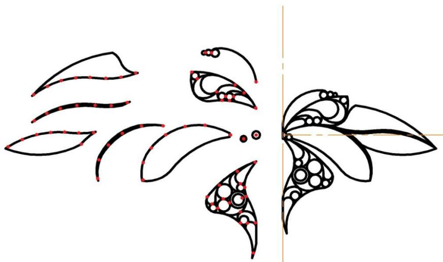
Рис. 3.3.05. Конструкция сборки броши «Somnia» с указанием мест соединения в графическом редакторе КОМПАС-3D
