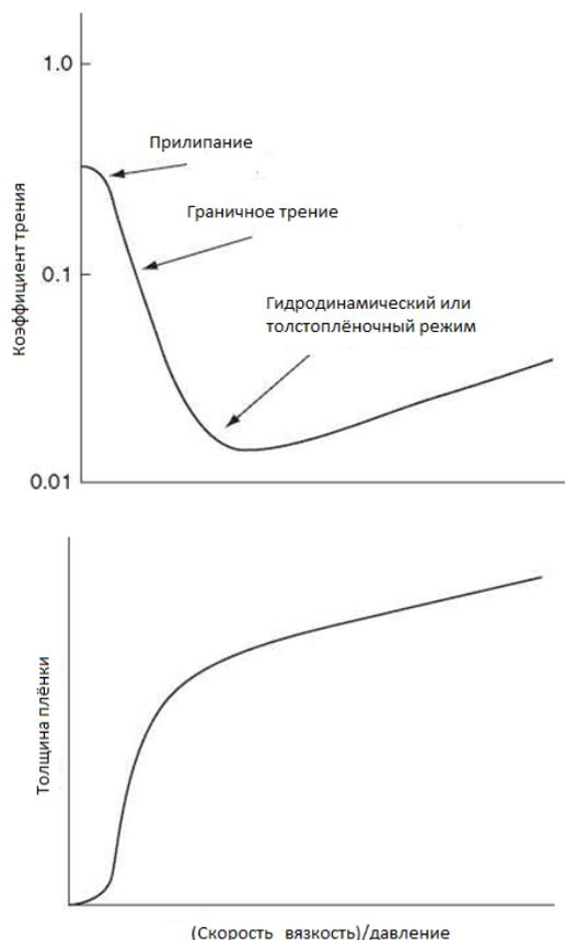
Рис. 6.1. Расчетные зависимости толщины смазочной пленки и коэффициента трения от скорости волочения
