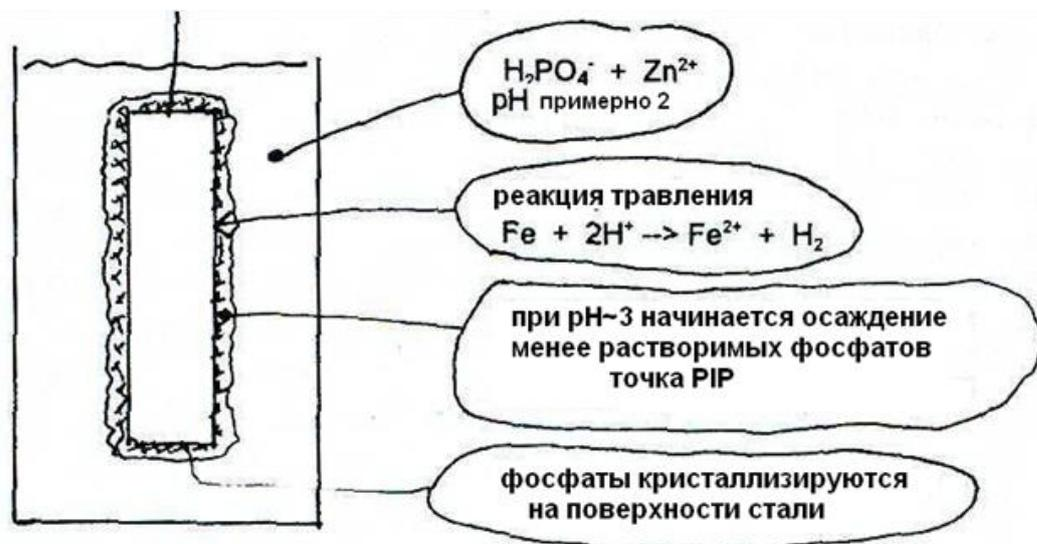
Рис. 7.13. Реакции, протекающие во время фосфатирования катанки
