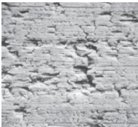
Рис.7.4. Поверхность алюминиевой проволоки, протянутой в условиях смазки, промежуточных между граничным и толсто пленочным режимами
