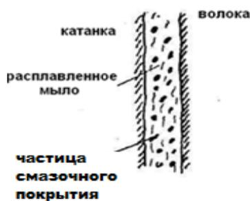
Рисунок 7.5.а Система смазки в волоке. Тонкая пленка между катанкой и волокой состоит из смазки и частиц смазконосителя
