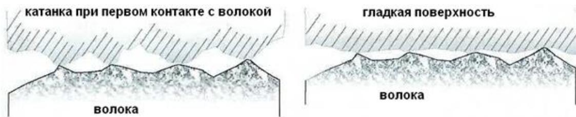
Рис. 7.8. Сглаживание грубой поверхности катанки
