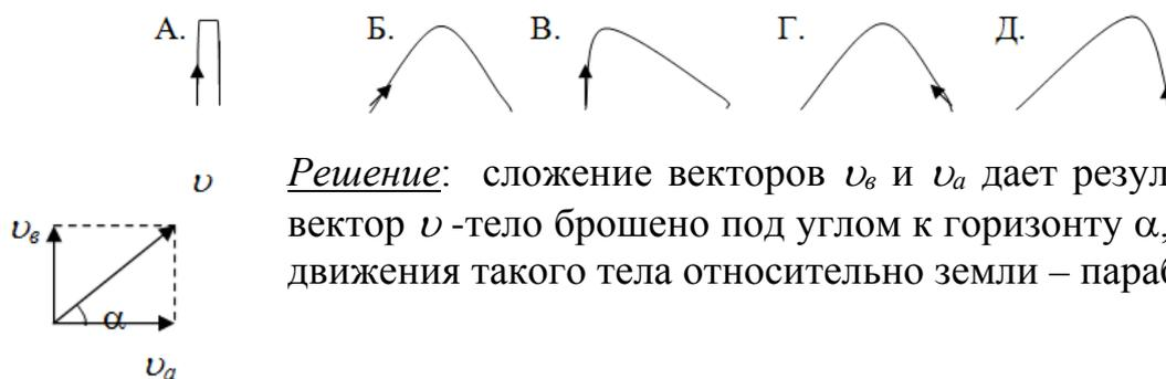
**Решение:** сложение векторов  $v_в$  и  $v_a$  дает результирующий вектор  $v$  - тело брошено под углом к горизонту  $\alpha$ , траектория движения такого тела относительно земли – парабола.
