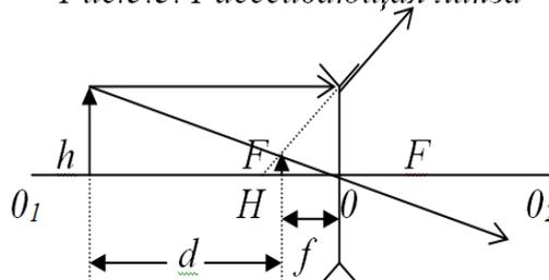
При построении изображений в линзах используют лучи, ход которых известен: луч, идущий параллельно главной оптической оси, преломляется и проходит через фокус  $F$  собирающей линзы (Рис.5.2), и рассеивается так, что его продолжение (пунктирная линия на Рис.5.3) проходит через фокус  $F$  (левый) рассеивающей линзы. Луч, идущий через оптический центр и для собирающей, и для рассеивающей линз проходит не преломляясь.
