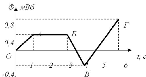
6. Зависимость от времени  $t$  магнитного потока  $\Phi$ , пронизывающего виток, показана на рисунке. Чему равен ток в витке в интервале В-Г, если его сопротивление равно  $0,05 \text{ Ом}$ ?
