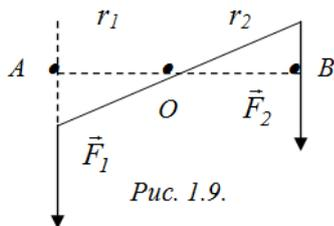
вращать тело (например, рычаг на Рис.1.9) против часовой стрелки, то момент  $M_1$  берут с плюсом:  $+M_1 = F_1 r_1$ , если по часовой ( $F_2$ ) – момент  $M_2$  с минусом:  $-M_2 = F_2 r_2$ , и тогда 2-е условие равновесия для этого примера  $M_1 - M_2 = 0 \Rightarrow M_1 = M_2$ , то есть  $F_1 r_1 = F_2 r_2$  – *правило рычага Архимеда*.
