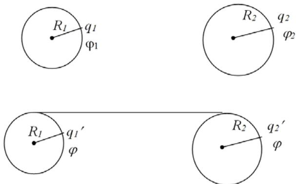
$$\text{Установим связь между параметрами: } \varphi_1 = \frac{kq_1}{R_1}; \varphi_2 = \frac{kq_2}{R_2}; \varphi = \frac{kq_1'}{R_1}; \varphi = \frac{kq_2'}{R_2}.$$
