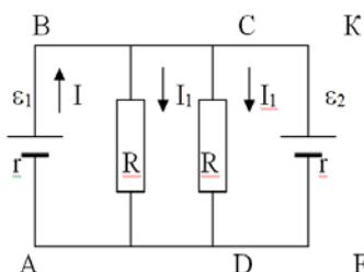
Решение: запишем закон Ома для полной электрической цепи для двух контуров: ABCD и ABKF:
