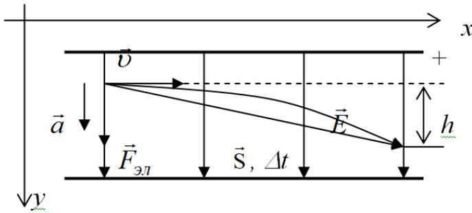
Частица движется по ветви параболы, так как  $\vec{v}$  и  $\vec{F}_{эл}$  направлены под углом  $90^\circ$ .
