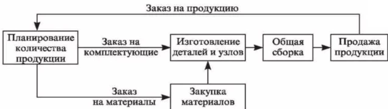
Рис. 12 Традиционная схема организации производства
