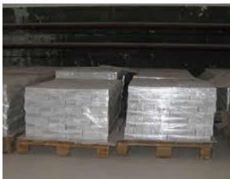
Рис. 4.3. Штабельная упаковка в термоусадочную пленку
