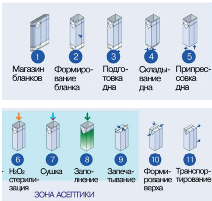
Рис. 4.11. Схема асептической упаковки
