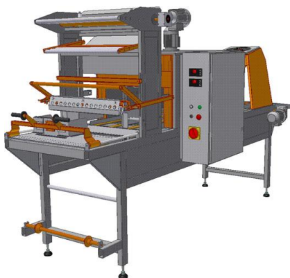
Рис. 4.4. Машина оберточная ручная МО-250, производительностью до 250 упаковок в час
