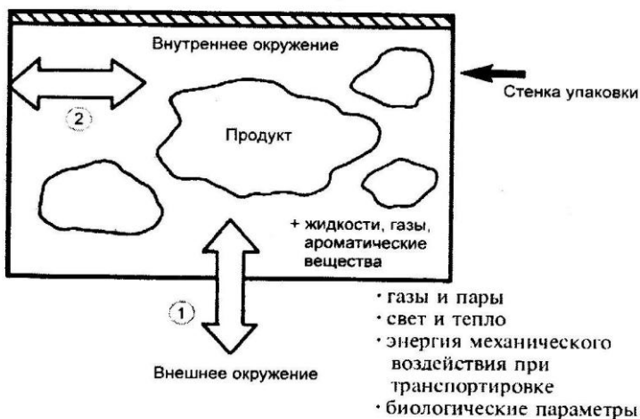
Рис. 1.1. Схема взаимодействия упакованного продукта с окружающей средой: 1 – взаимодействие между внутренней и внешней средами; 2 – взаимодействие между упакованным продуктом и упаковочным материалом
