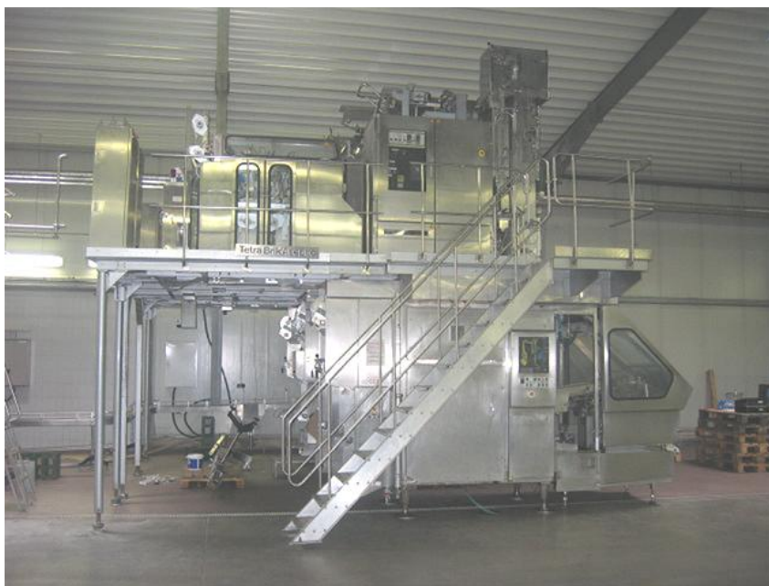
Рис. 4.14. Асептическая линия розлива Tetra Pak TBA/8 производительностью 6 000 упак/час
