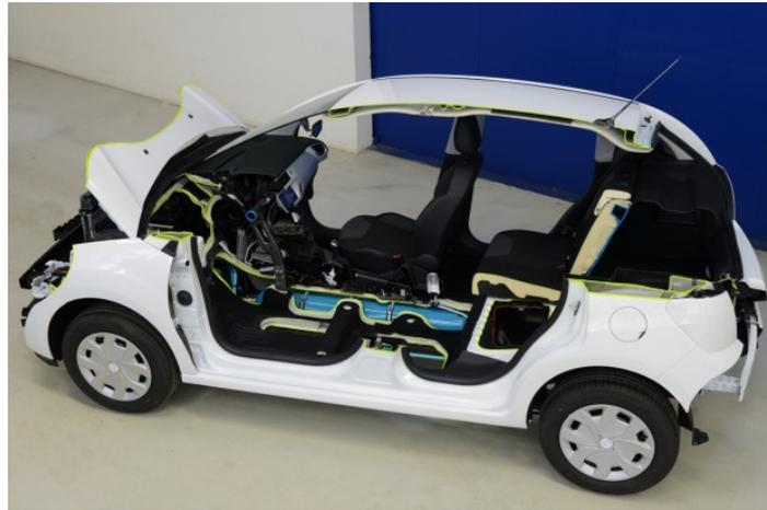
Schnittmodell eines Citroën C3 mit HybridAir-Technik. Deutlich zu sehen ist die blaue Stahlflasche unterm Fahrzeugboden, die Druckluft speichert, mit der das Auto streckenweise angetrieben werden kann
