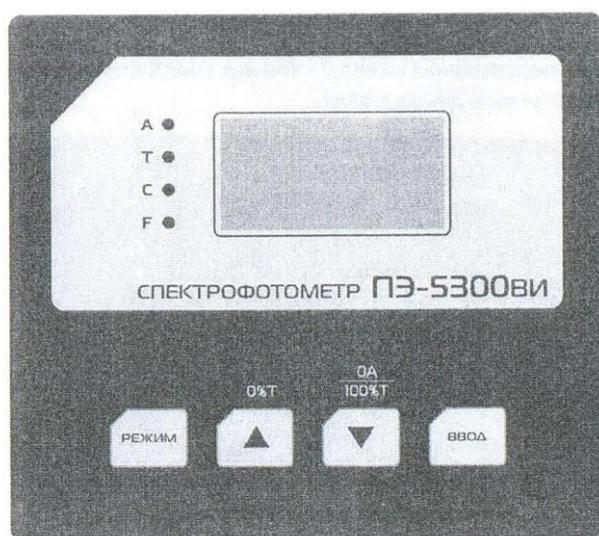
Рис. 3. Панель управления спектрофотометра ПЭ - 5300 ВИ
