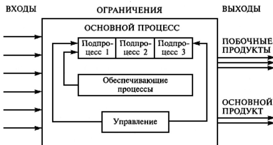
Рис. 2. Модель процессной системы
