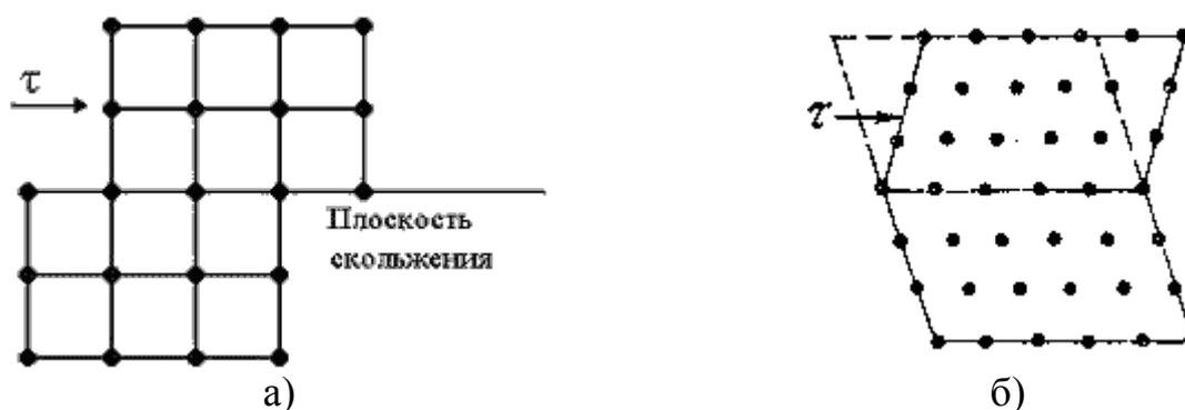
Рис.2.1.5. Схемы пластической деформации различными способами: а – скольжением; б – двойникованием
