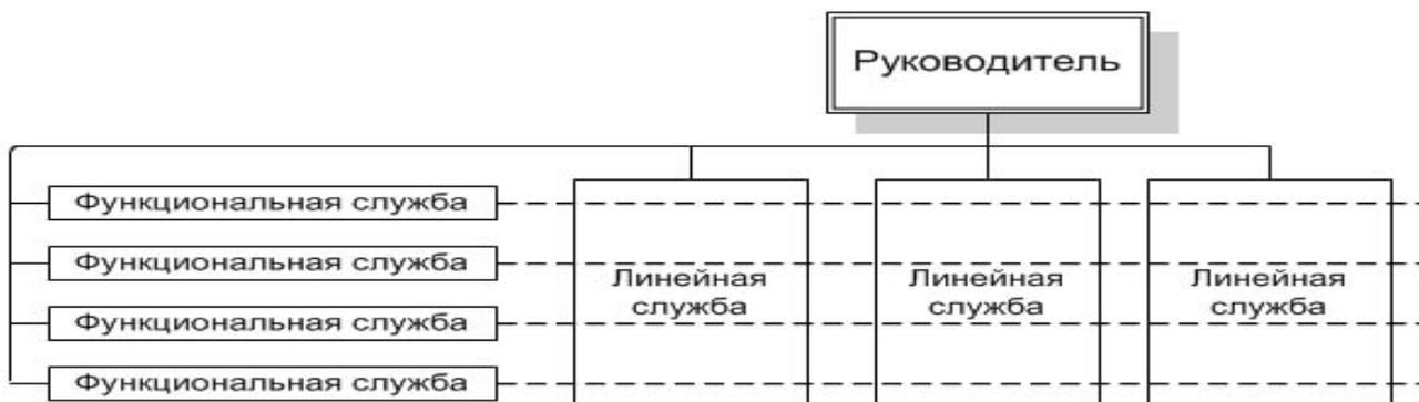
Рис.Б.3. Линейно-функциональная организационная структура управления
