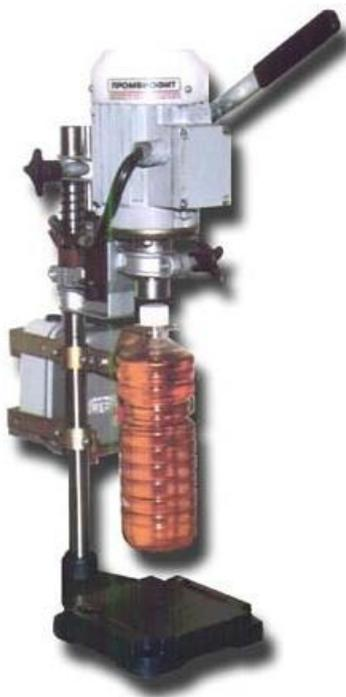
Рис. 16. Полуавтоматическое устройство укупорки модели УУ-3
