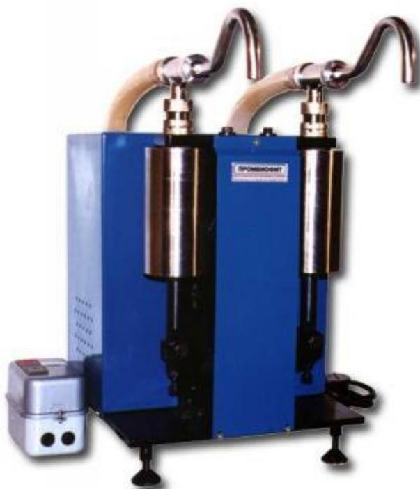
Рис. 13. Установка розлива УД-2
