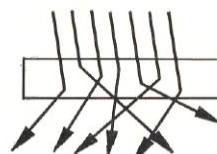
Рис. 2.6. Ход лучей и рассеивание просвечивающим веществом
