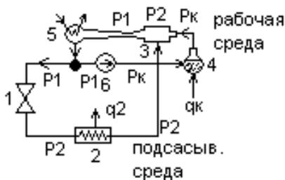
Рис.6.10. Схема парожеторной холодильной установки
