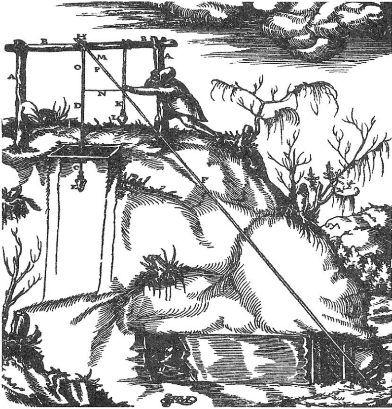
Рис. 1. Столбы (стойки) – А; поперечина – В; шахтный ствол – С; первый шнур – D; груз на первом шнуре – Е; второй шнур – F; закрепление того же шнура на земле – G; начало первого шнура – H; устье штольни – I; третий шнур – K; груз на третьем шнуре – L; первый размер (измерение) – M; второй размер (измерение) – N; третий размер (измерение) – O; треугольник – P
