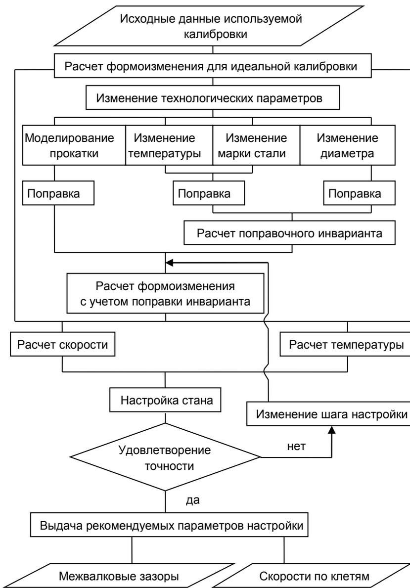
Рис. 2.4. Общая блок-схема модели настройки сортового стана
