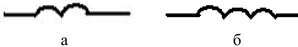
Рис. 1.7. Обмотка: а – токового реле; б – реле напряжения
