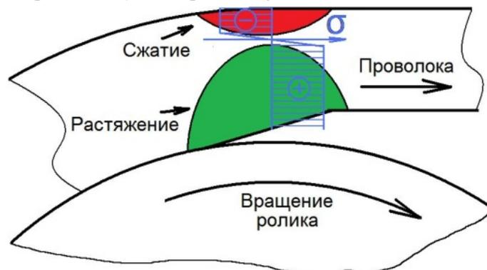
Рис. 8. Схема области схода катанки с ролика
