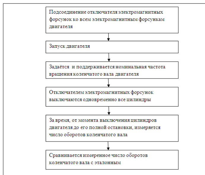
Рис. 26. Схема третьего этапа технологического процесса комплексного диагностирования ДВС - диагностика выпускного тракта
