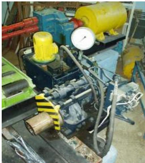
Рис.9.1. Общий вид гидропривода моталки и сталькивателя рулона
