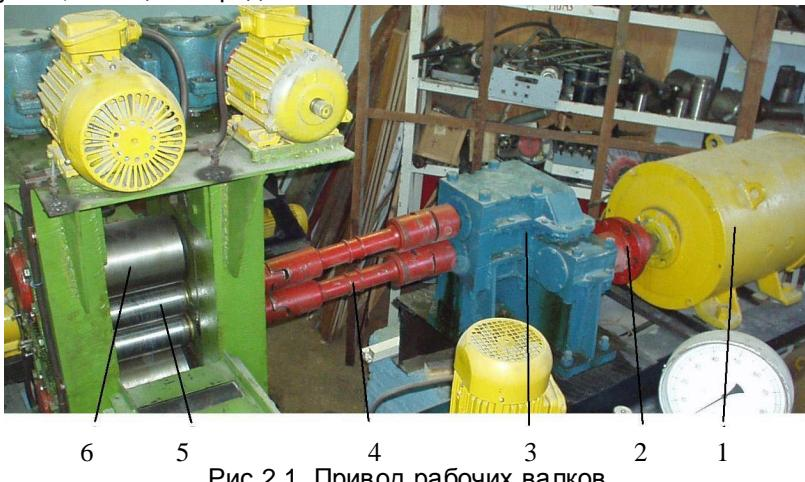
Рис.2.1. Привод рабочих валков
